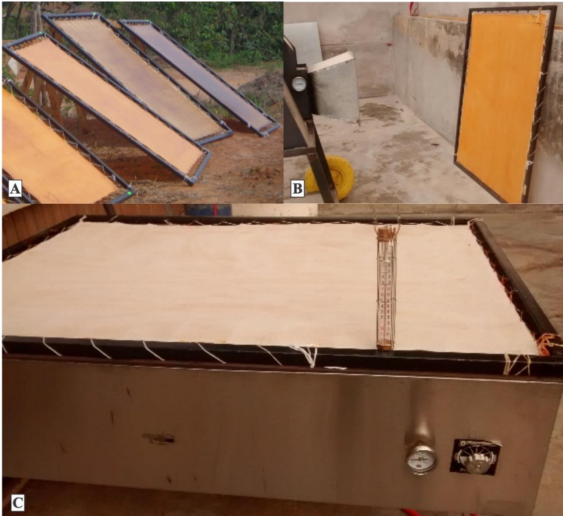
Figura 1S. Tipos de secado de las láminas vulcanizadas (a) secado al sol, (b) calefactor, (c) estufa
