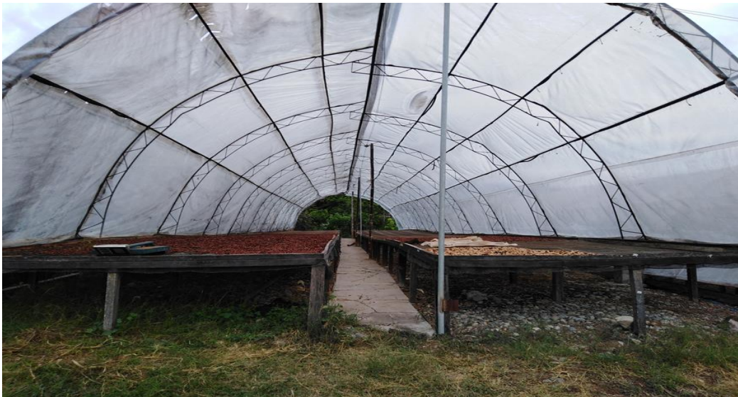
Figura 4S. Secador solar tipo túnel utilizado por la Cooperativa APROCAM
