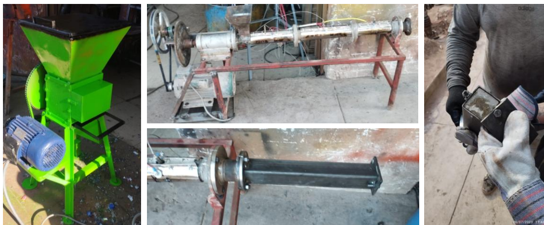
Figura 1. Equipos y de producción de ladrillos con PET extruido.
