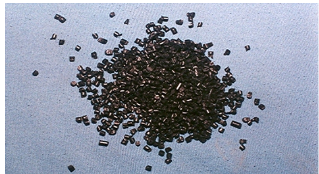
Figura 1. Pellet de reciclaje de polipropileno. Nota. Este pellet fue producido en la empresa PROCOMSAC – Chiclayo.
