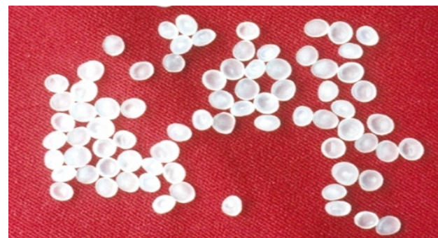
Figura 2. Pellet virgen de polipropileno. Nota. Este pellet no es producido en el Perú.
