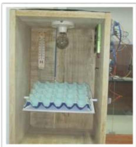
Fotografía 1. Incubadora construida - Estructura
