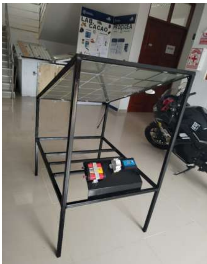
Figura 4. Montaje del sistema del panel solar y componentes en la estructura metálica.
